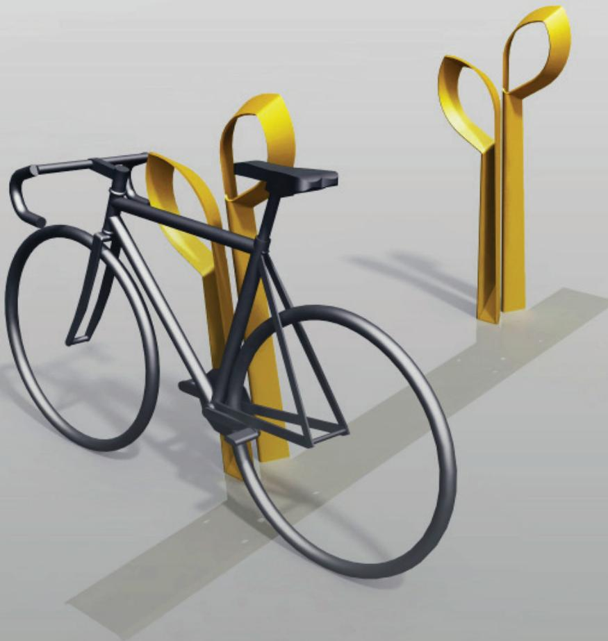
Med Løv får hver sykkel sitt eget stativ. Man lener sykkelen mot sideflatene på stativet og låser sykkelen i øyet. I tillegg til rett og skråstilt variant, leveres Løv i 3 ulike høyder tilpasset forskjellige gatedekker. Stativene leveres ferdig montert på skinne for forankring i bakken.
