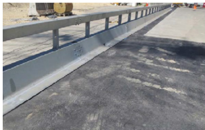
Underlag: VarioGuard er testet plassert på asfalt.
