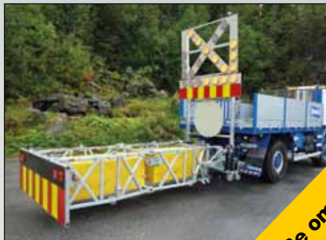
Panel med lyspil for støtputer.
