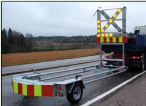
Panel med lyspil for påkjøringshengere.
